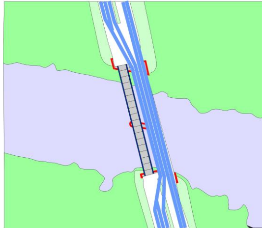
Variante 2: Einsatz einer System- Behelfsbrücke
